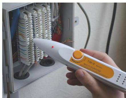
4. При включении параллельно с работающей телефонной линией прибор отобразит состояние линии при помощи светодиодов (свободна, разговор, посылка вызова).
