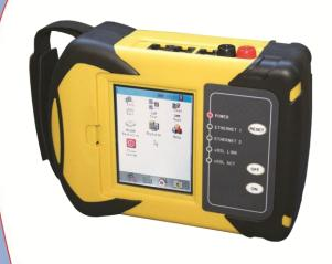
Полнофункциональный VDSL анализатор KIWI-2210 позволяет легко идентифицировать и решать проблемы в как в VDSL каналах, так и в каналах, использующих технологии ADSL/ADSL2/ADSL2+.
