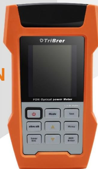
KIWI-4550 – Измеритель мощности для сетей PON нового поколения. Прибор включается в разрыв оптической линии и производит одновременное измерения уровня сигнала от ONT, ONU и кабельного телевидения. Прибор позволяет задавать пороговые значения и проводить автоматическую оценку линии «годен – не годен». Результаты измерения сохраняются во внутренней памяти и могут быть переданы на компьютер.
