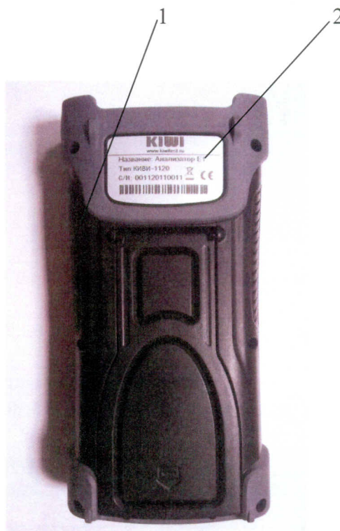
1 - место установки пломбы; 2 - место нанесения маркировки Рисунок 2
