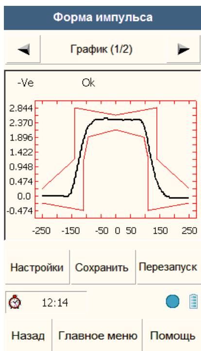
Рис 3-25 Графические результаты измерений маски импульса
