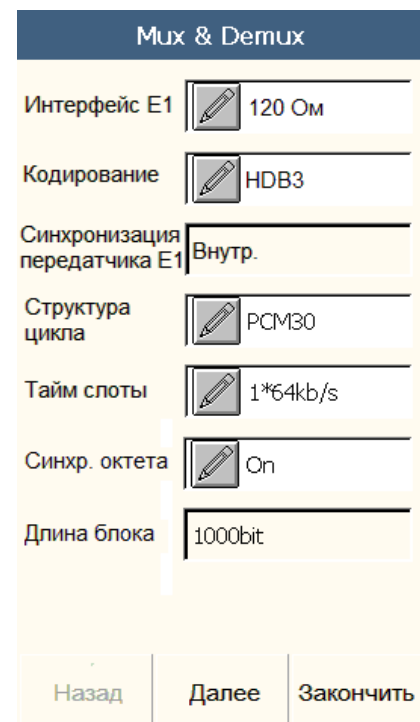
Рис 3-55 Настройки в режиме «Mux & Demux»
