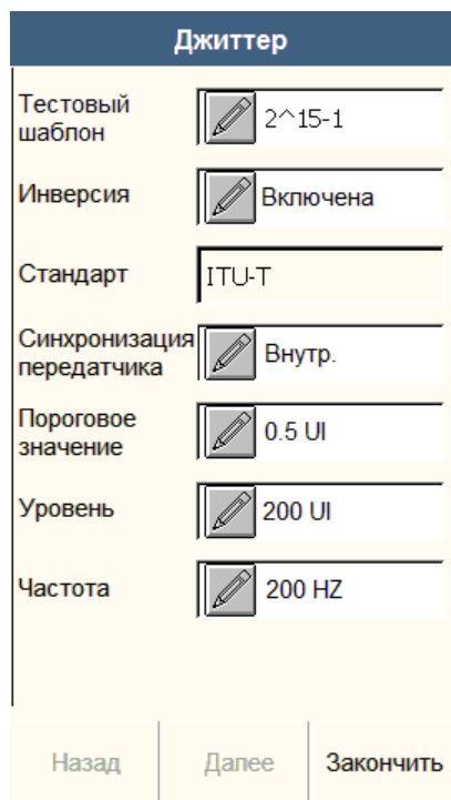
Рис 3-28 Настройки измерения джиттера
